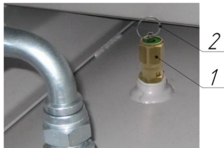
Рисунок 9 – Клапан предохранительный пружинного типа
