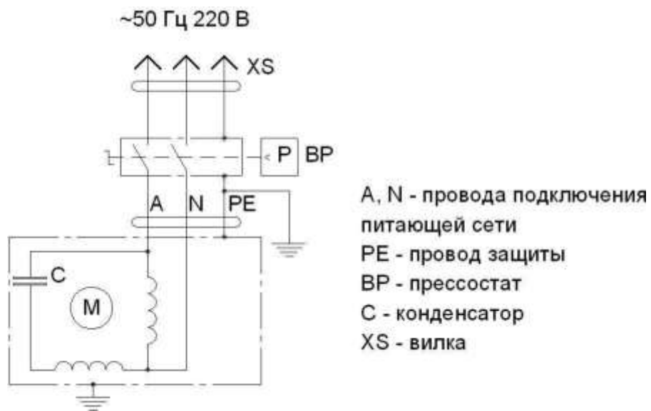
Рисунок А.1 - Схема электрическая принципиальная компрессоров СБ4/С-20.Ј1047В, СБ4/С-24.Ј1047В, СБ4/С-50.Ј1047В, СБ4/С-20.Ј1048В, СБ4/С-24.Ј1048В, СБ4/С-50.Ј1048В
