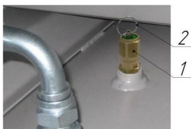
Рисунок 8 – Клапан предохранительный пружинного типа
